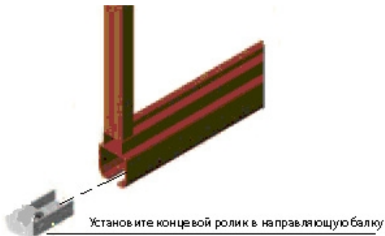
Рис. 9. — Установка концевого ролика в направляющую балку.
