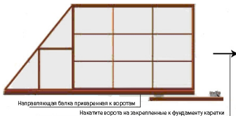
Рис. 7. — Установка ворот на каретки.
