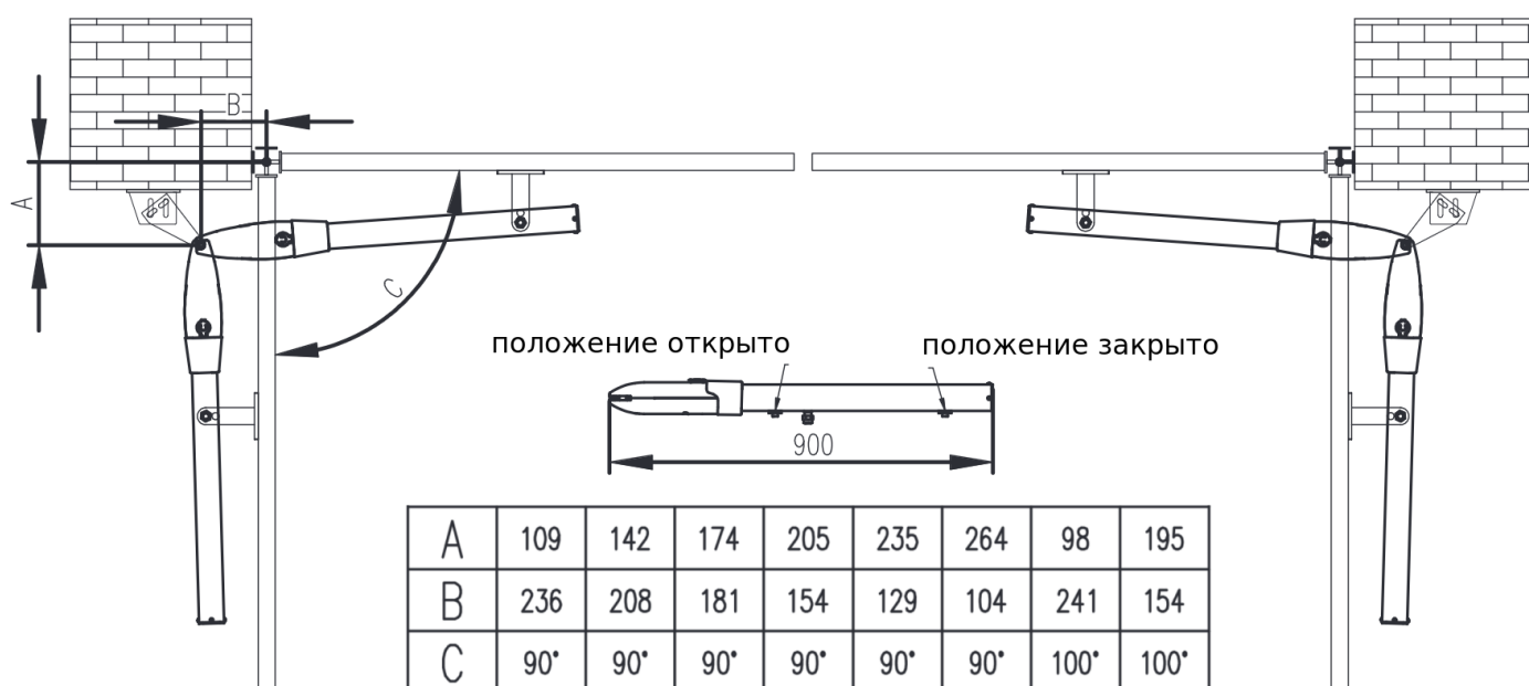
Рис. 2 Монтажные размеры для открытия во внутрь территории (Размеры А, В, С, D, представлены в мм, размер Е в градусах)
